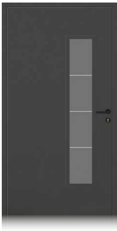
DIMENSIO 5 - Innenansicht | verglast Beidseitig flügelüberdeckend - Innen DB703 Glas sandgestrahlt mit klaren Rand und Streifen Innendrucker auf Rundrosette mit PZ-Rundrosette schwarz Türband verdeckt liegend
