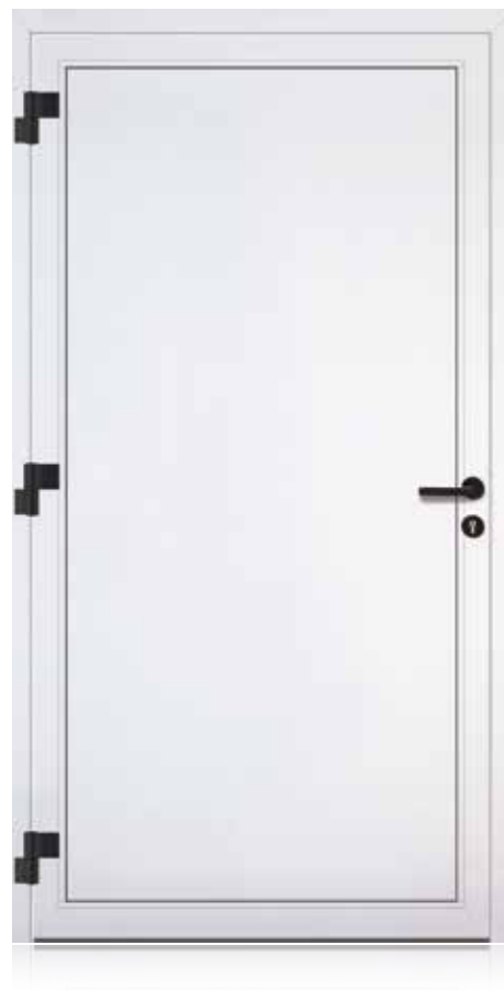
DIMENSIO 2 - Innenansicht | geschlossen Außen flügelüberdeckend Innen Verkehrsweiß RAL9016 Innendrücker auf Rundrosette mit PZ-Rundrosette schwarz Aufschraubtürband 2-teilig schwarz
