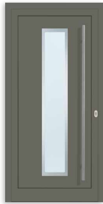
Zentra II Verglasung Satinato weiß Sonderausstattung: Rahmen in Edelstahloptik Außen Dekor Quarzgrau Sandstruktur foliert Edelstahl Stoßgriff 1.600 mm mit geraden Stützen auf der Füllung montiert
