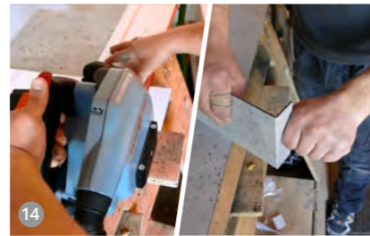
14 Fräskanttechnik* Die Platten können mit einer V-Nutfräse rückseitig mit einer Einkerbung versehen werden, an der die Platte präzise von Hand gebogen werden kann. Dadurch ergibt sich eine geschlossene Außenkante.
