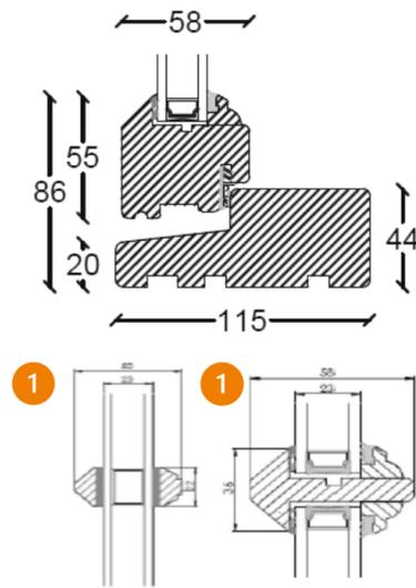
1. Schmale 22 mm aufgeklebte oder 36 mm echte, glasteilende Sprossen
