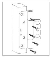
Den Bandlappen an der Tür mit Schrauben 5 x 50 mm befestigen.
