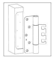
Die Fräsung vornehmen, Fräser 24 mm Ø, unterschiedliche Frästiefenangaben beachten, den Bandlappen einsetzen.
