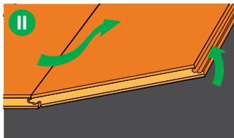
Benutzen Sie ausreichend Holzkeile, um die Dehnungsfuge während der Verlegung zu fixieren. Es ist zu empfehlen, die Dielen längs zum Hauptlichteinfall zu verlegen, in länglichen, schmalen Räumen ist immer eine längsseitige Verlegerichtung empfehlenswert. Ferner sollten Sie an einer geraden Wand des Raumes beginnen.
