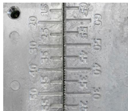
Der verstellbare Streifenschneider dient zum Anfertigen von Belagsstreifen, welche in die Kernsockelleisten der Typen C 60 life Top und D 60 life Top eingesetzt werden können.
