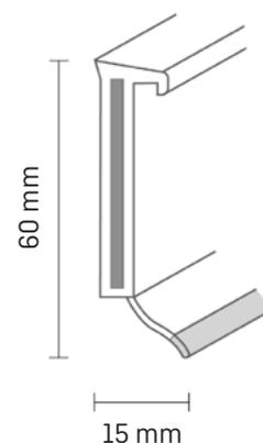
Geeignet für Designbeläge mit einer Materialstärke bis zu 4,5 mm.
