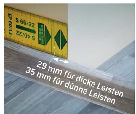
Markierung an die Kante der Anschlagfläche ausrichten, Klemmhebel komplett schließen...
