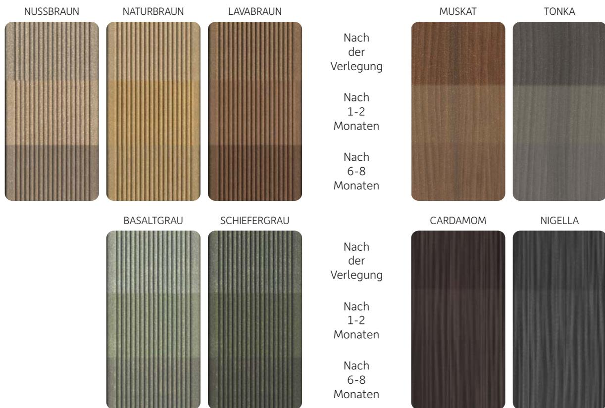
Die natürliche Farbreifung wird im Schnellbewitterungsgerät überprüft. Dabei wird Sonneneinstrahlung und Feuchtigkeit in periodischen Wechsels simuliert, 1000 Stunden Bewitterung entsprechen in etwa einem Jahr Außenbewitterung.
