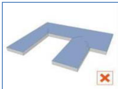
Abbildung 12/13: Ausführung von Innenaussparungen (proHPL)
