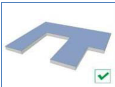
Abbildung 12/13: Ausführung von Innenaussparungen (proHPL)
