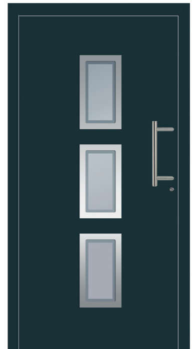
MOSKAU - Aluminium-Haustür einseitig flügelüberdeckend außen, Rahmen in Edelstahloptik außen, Glas: 3-fach WSG Ug 0,7, Sandstrahlmotiv: Y1800, Farbe: ähnl. RAL 7016 Anthrazitgrau
