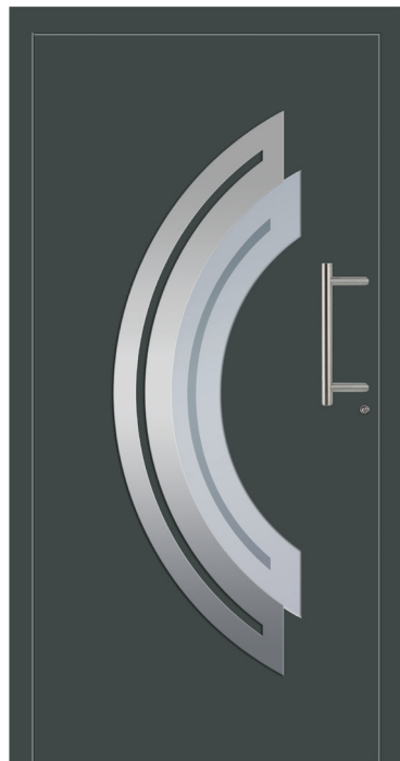
ROM - Aluminium-Haustür einseitig flügelüberdeckend außen, Applikation in Edelstahloptik außen, Rahmen in Edelstahloptik innen, Glas: 3-fach WSG Ug 0,7, Sandstrahlmotiv: Y933, Farbe: ähnl. RAL 7012 Basaltgrau
