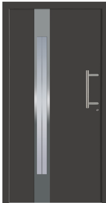
PEKING - Aluminium-Haustür einseitig flügelüberdeckend außen, Applikation in Edelstahloptik außen, Rahmen in Edelstahloptik innen, Glas: 3-fach WSG Ug 0,7, Sandstrahlmotiv: Y1822, Farbe: ähnl. DB 703 Eisenglimmer
