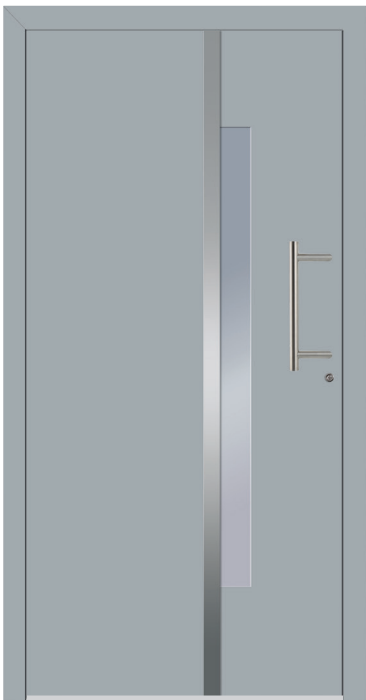
BERLIN - Aluminium-Haustür einseitig flügelüberdeckend außen, Applikation in Edelstahloptik außen, Rahmen in Edelstahloptik innen, Glas: 3-fach WSG Ug 0,7, Farbe: ähnl. RAL 7001 Silbergrau
