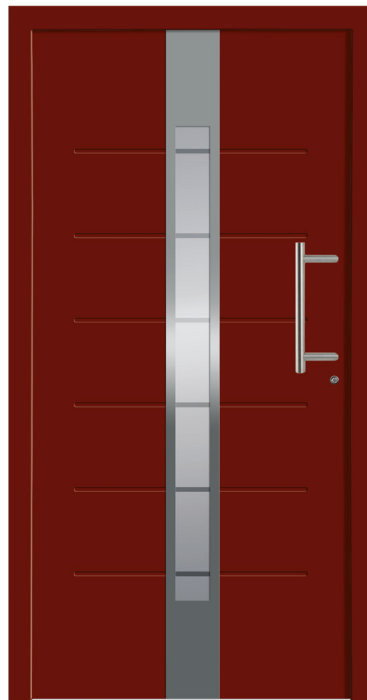
LISSABON - Aluminium-Haustür einseitig flügelüberdeckend außen, Applikationen in Edelstahloptik und Nuten außen, Rahmen in Edelstahloptik innen, Sandstrahlmotiv: Y887, Glas: 3-fach WSG Ug 0,7, Farbe: ähnl. RAL 3004 Purpurrot
