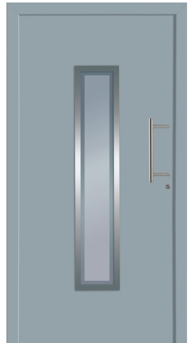
LONDON - Aluminium-Haustür einseitig flügelüberdeckend außen, Rahmen in Edelstahloptik außen, Glas: 3-fach WSG Ug 0,7, Sandstrahlmotiv: Y1816, Farbe: ähnl. RAL 7001 Silbergrau
